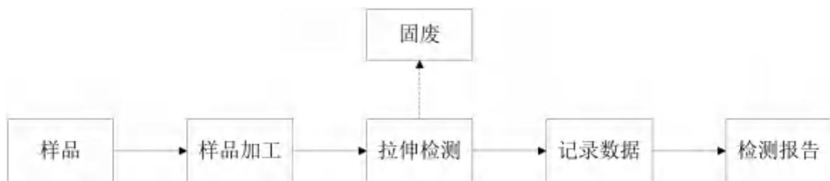
图2-5 钢管、工字钢、管材、止水材料、土工合成材料等检测流程及产污节点图
