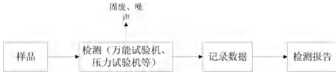
图2-1 钢筋、土工、砖、混凝土及砂浆试件中间产品、岩石等试验艺流程及产污节点图
